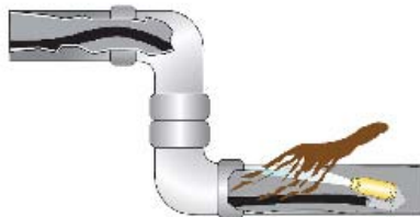
ทำความสะอาดท่อกับด้วยแรงดันน้ำ 3000
